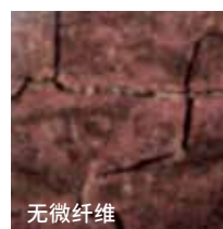
经循环起泡试验箱试验后的涂层状态：有微纤维增强的涂层未发现开裂。无微纤维的涂层则严重开裂。
