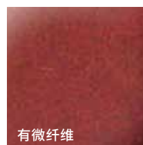
经循环起泡试验箱试验后的涂层状态：有微纤维增强的涂层未发现开裂。无微纤维的涂层则严重开裂。
