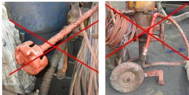
图1.吸入管和搅拌器的湿端不符合要求。使用前须彻底清洁所有部件
