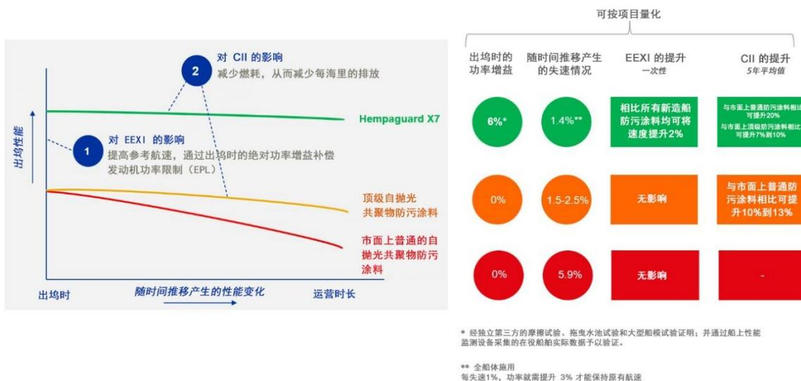
图1: Hempaguard与传统防污漆相比对船只在燃油节省性能上的影响（转换为CII和EEXI的提升值）
