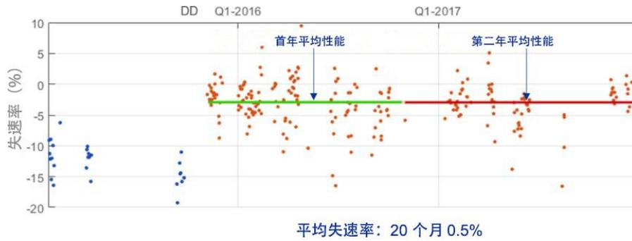
图10：运营3年的油轮（超大型油轮）随时间推移因船体积污而导致的速度变化
