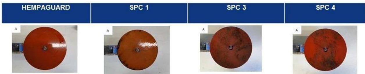
图6: Hempaguard®和三种高端传统防污涂料的涂层暴露于海洋环境一个月后的外观。
